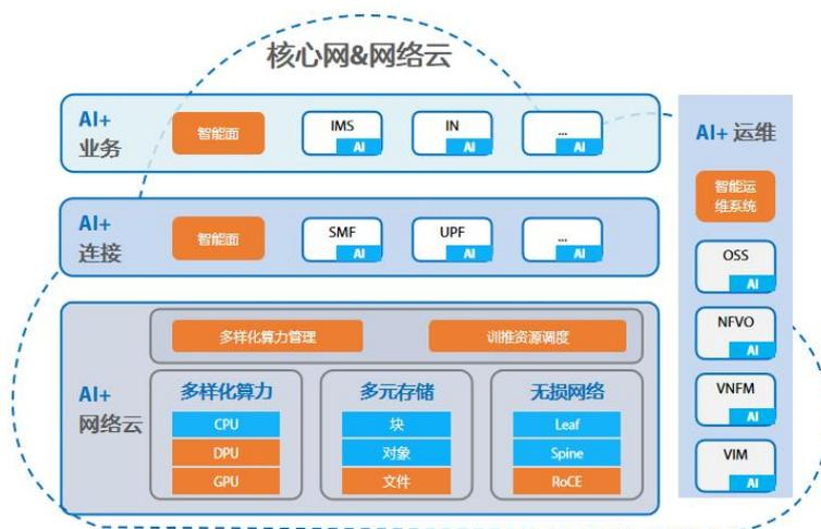
图 3-1 “AI+”核心网技术体系架构
