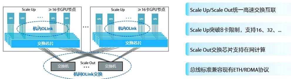
图 7-3 高通道无损网络架构
