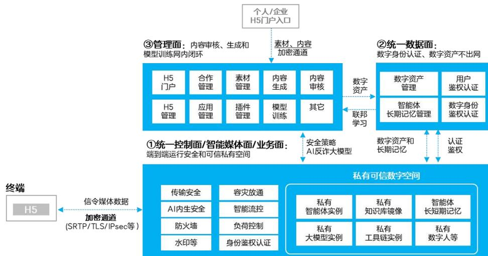
图 4-25 AI+新通话端到端安全架构
