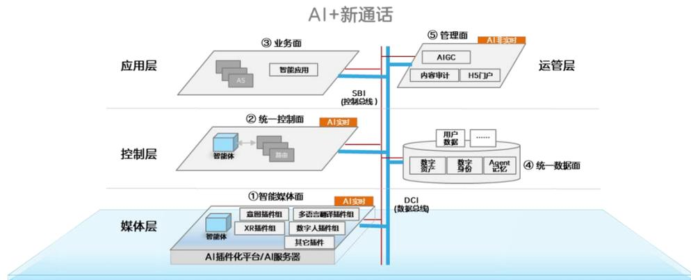
图 4-9 AI+新通话“四层五面”架构
