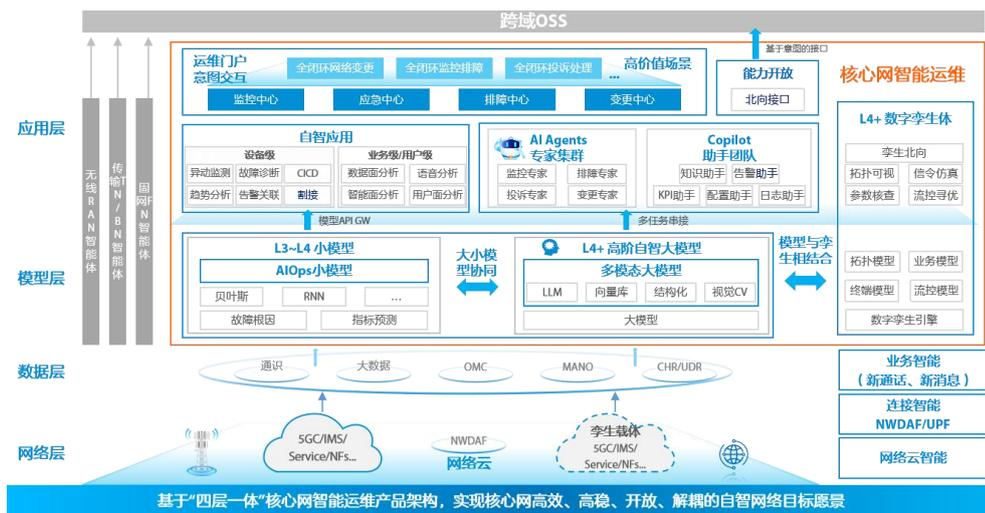
图 6-2 “四层一体”核心网智能运维架构
